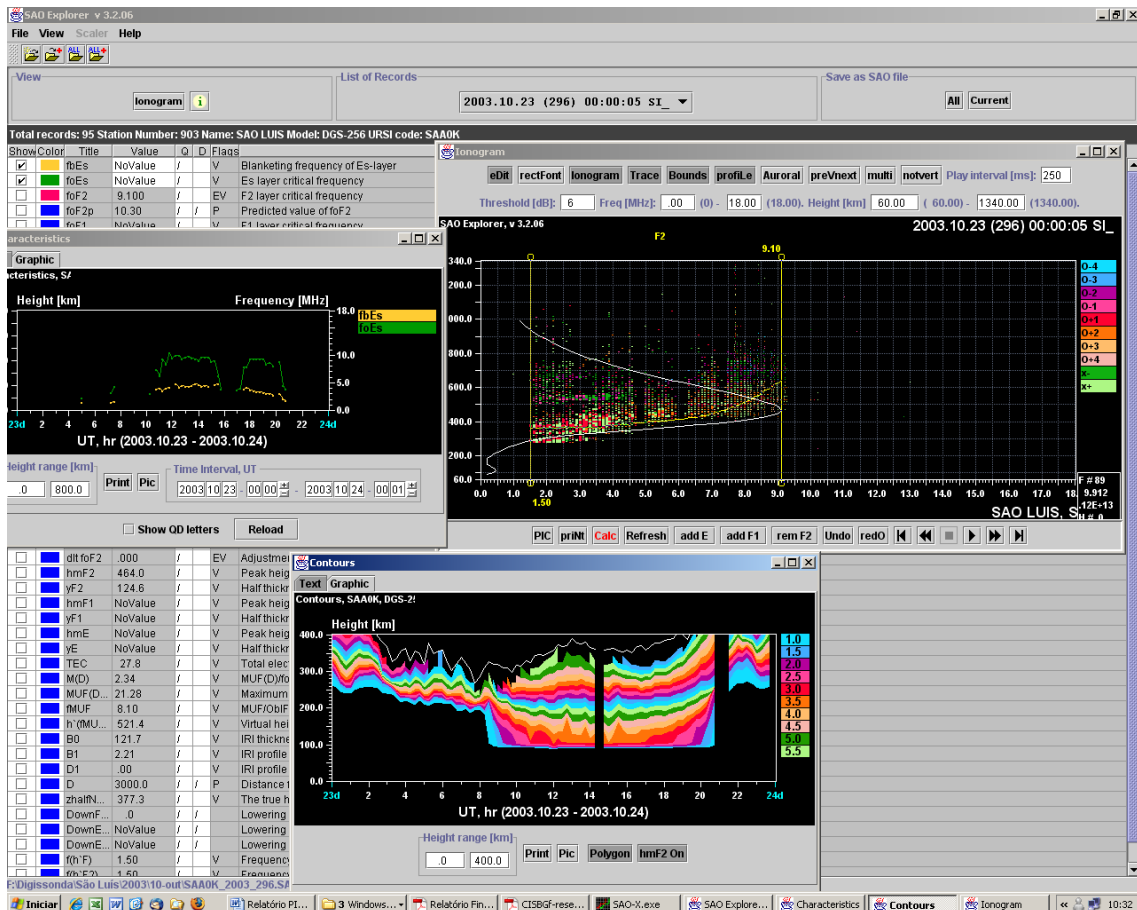
Figura 1.6- Ilustração do programa SAO-Explorer onde são visualizadas as diversas telas para manipulação e visualização dos ionogramas e parâmetros ionosféricos.
